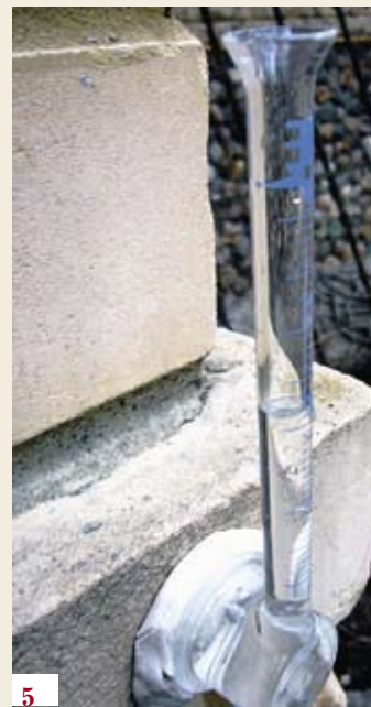
5 За 2 часа столбик воды в трубке Карстена понизился на 18 делений (1,8 мл)
