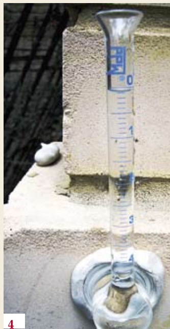
4 За 2 часа столбик воды в трубке Карстена понизился на половину деления (0,05 мл)
